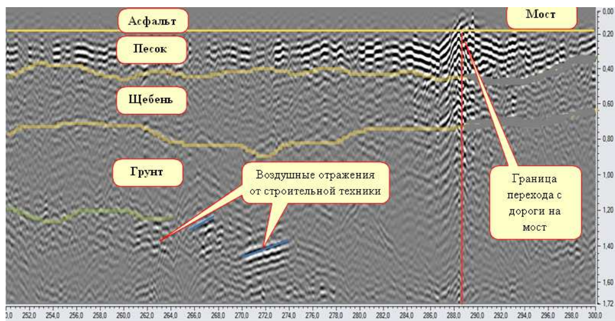
Рис. 3. Участок профиля 1: 250 – 300 м. (с выходом на мост в конце профиля).
