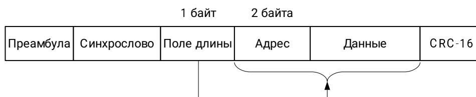
Рис. 2. Общий формат кадра радиосети
