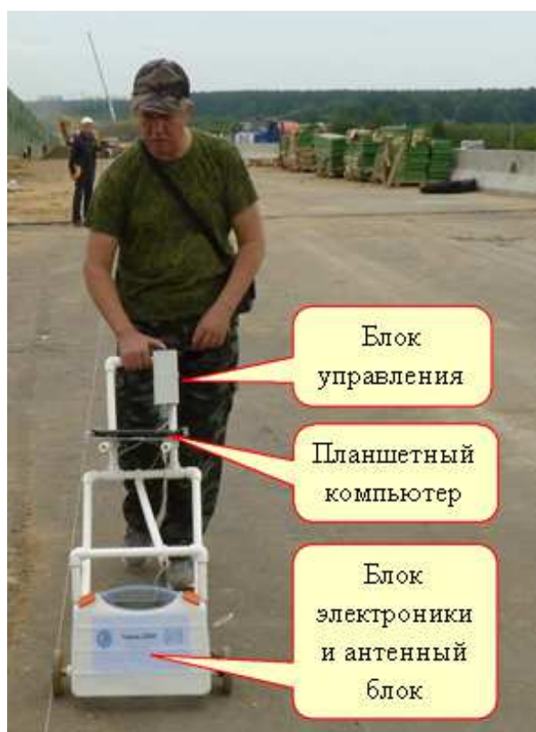
Рис. 1. Внешний вид георадара «Герад-2200».
