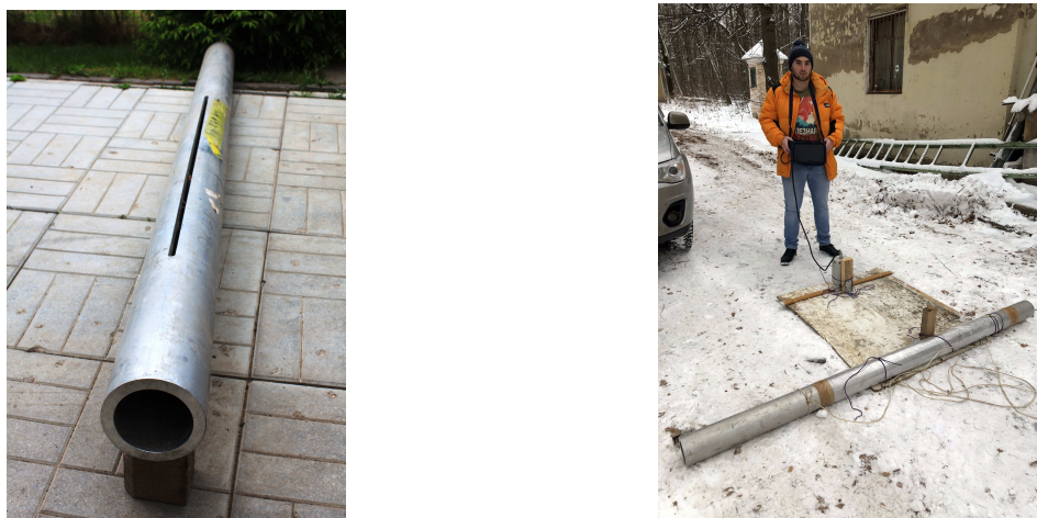
Рис. 4. Макет и натурные испытания щелевой антенны.
