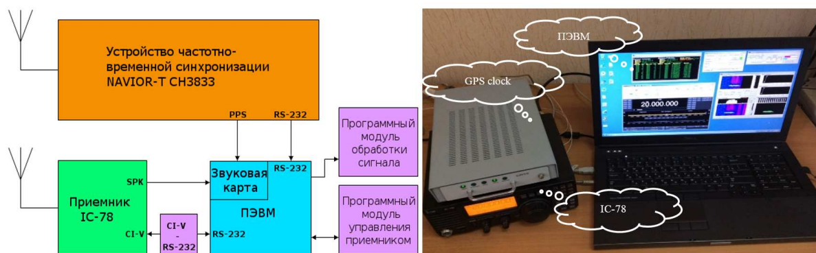
Рис. 1. Блок-схема устройства для пассивного зондирования ионосферного КВ радиоканала и внешний вид пассивного ЛЧМ ионозонда
